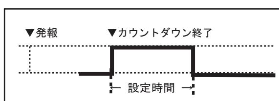
イ) 「連続」を選択すると発報と同時に出力動作を開始します。キャンセル報受信、もしくはDIでの入力、CREARボタン長押しがない限り出力ONの状態を維持します。
