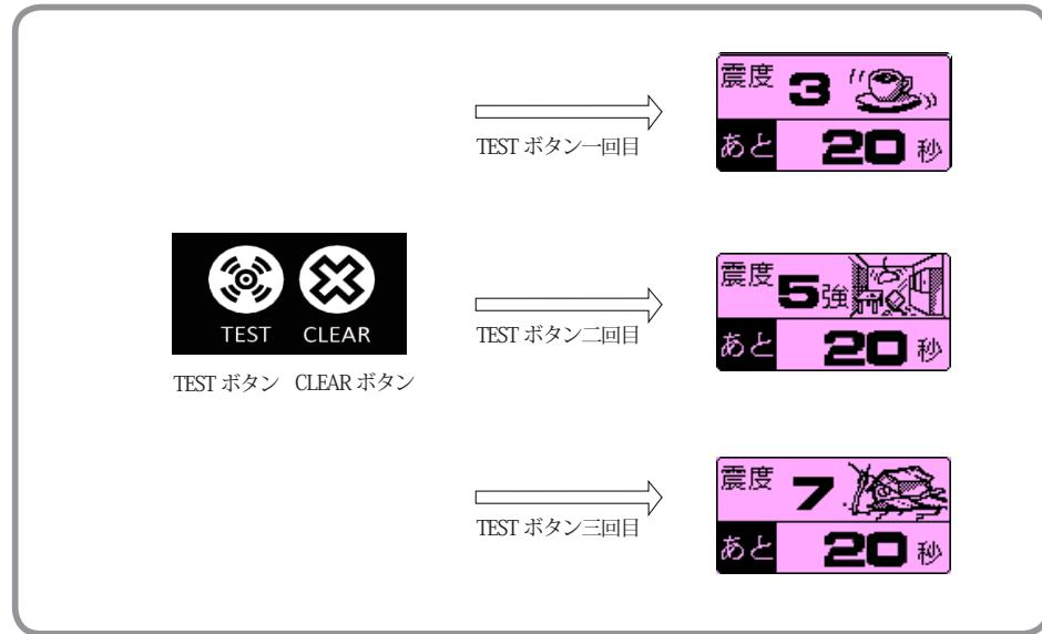
本体の TEST ボタンを約 3 秒長押すことより、地震速報のテストの報知が実行できます。一回目は震度 3、二回目は震度 5 強、三回目は震度 7、4 回目は震度 3 にもどり報知します。
