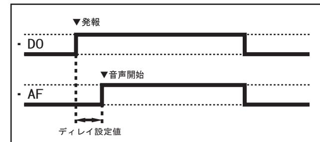
② DO 設定情報 : 地震 / 津波 /DI から選択し、接点を出力します。
