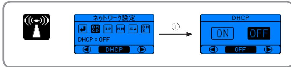
DHCP (IP 自動取得) 「OFF」にしますとネットワーク情報 (IP アドレス、ゲートウェイ、サブネットマスク、DNS) 入力が必要になります。
