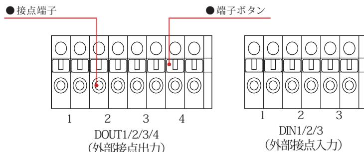
※無電圧ループ接点になっています。定格電圧(38V)を超える電圧は与えないでください。故障の原因となります。
