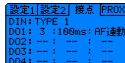
接点について出力設定(DO1、DO2、DO3、DO4)及び入力(DIN)の設定情報が確認できます。
