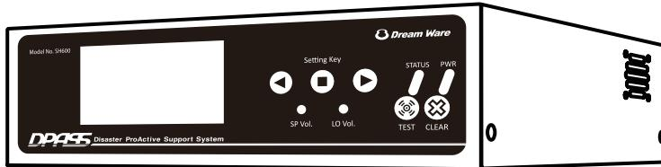
本製品は緊急地震速報を受信し、各地での震度、到達時間を瞬時に予測演算し報知を行うものです。
