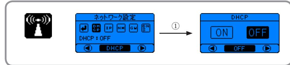
DHCP (IP 自動取得)「OFF」にしますとネットワーク情報 (IP アドレス、ゲートウェイ、サブネットマスク、DNS) 入力が必要になります。
