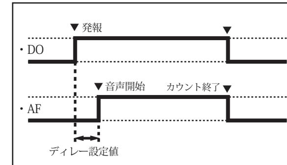
② DO 設定情報 : 地震 / 津波 /DI から選択し、接点を出力します。
